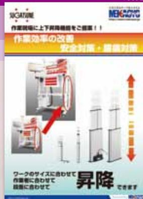
昇降装置は、工場の生産設備や作業台の高さを調整できる装置です。作業効率の改善、安全対策、腰痛対策に最適です。異なる作業を一カ所で行う場合、扱うものによって高さを変えたり、様々な人が同じ作業台を使用する場合、作業者に合わせて高さを変えるなど、上下昇降がもたらす効果は産業分野にこそ発揮されます。標準タイプのほか、ロングストロークタイプやタフタイプなど幅広いバリエーションをご用意しています。
