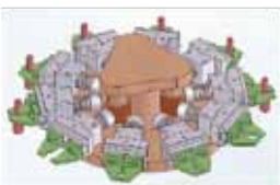
【アプリケーション例】 エア配管がないのでインデックステーブルでの旋回が可能
