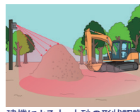
建機による土・土砂の形状認識
